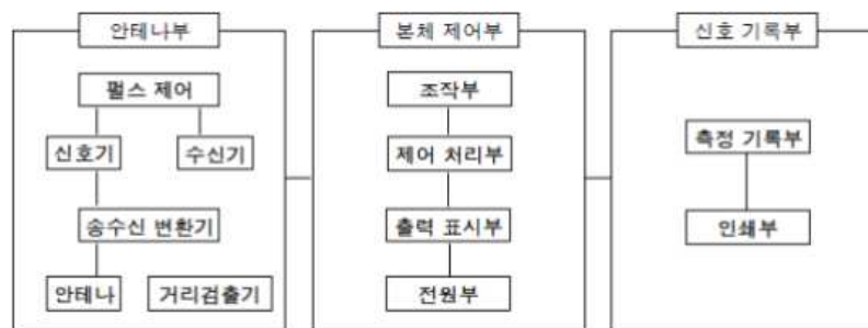
<그림 3.15> 전자파 레이더법에 의한 철근탐사장비의 장치 구성도
